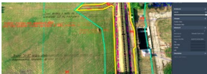
Rys. 3. Integracja chmury punktów z nalogu LiDAR z projektem 2D.
